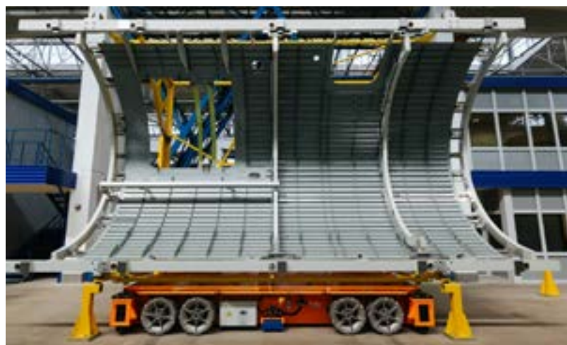
Панель фюзеляжа самолета МС-21 на станции новой сборочной линии
